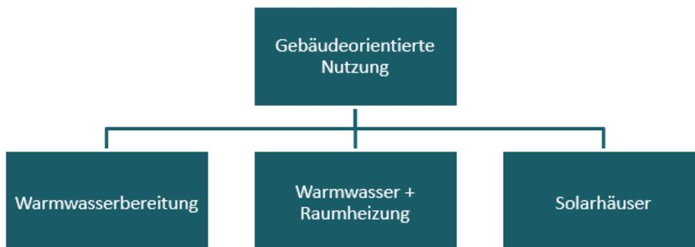
Abbildung 9: Arten der gebäudeorientierten Nutzung von Solarthermie
