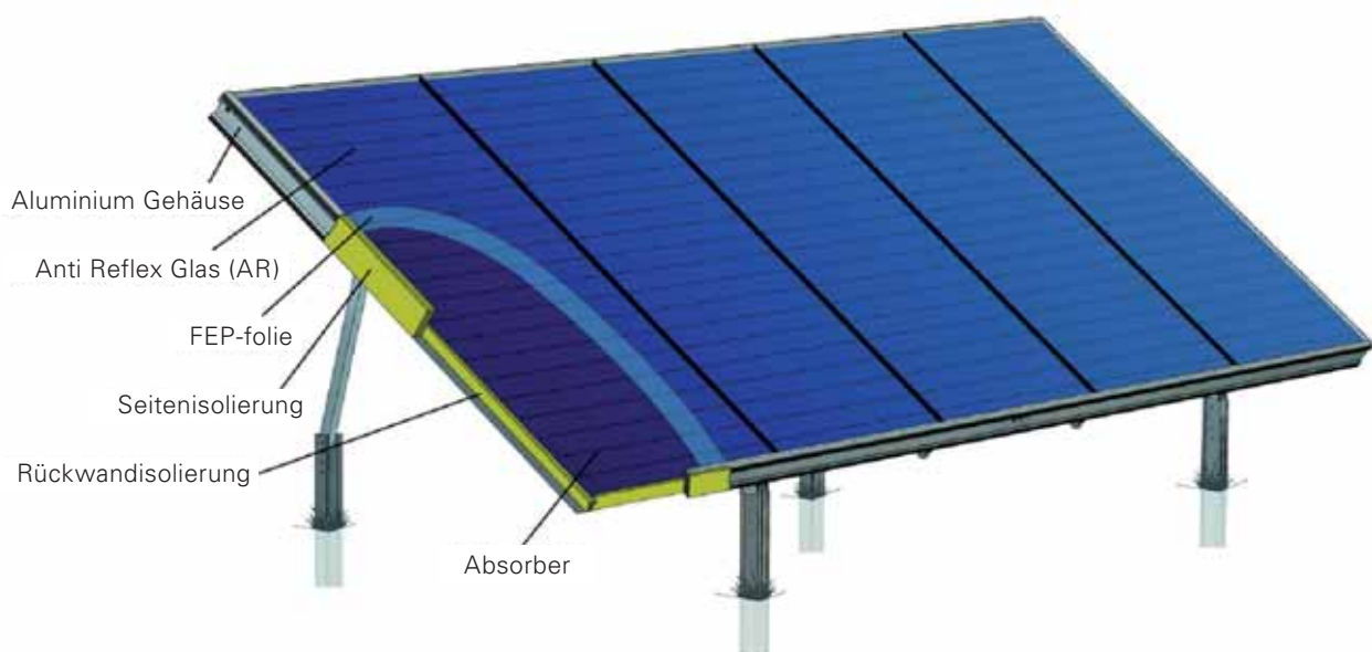
BILD 15: Aufbau eines HT-Flachkollektors.
