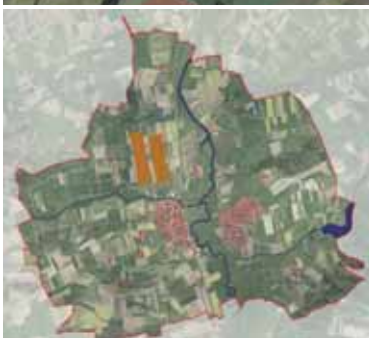
BILD 13: Beispielhafte Darstellung der zur vollständigen Wärmeversorgung einer Gemeinde theoretisch erforderlichen Flächen für Solarthermie und für Biomasse.
