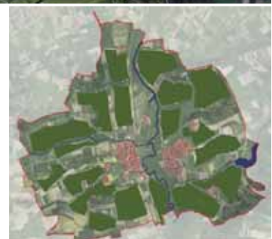
BILD 13: Beispielhafte Darstellung der zur vollständigen Wärmeversorgung einer Gemeinde theoretisch erforderlichen Flächen für Solarthermie und für Biomasse.
